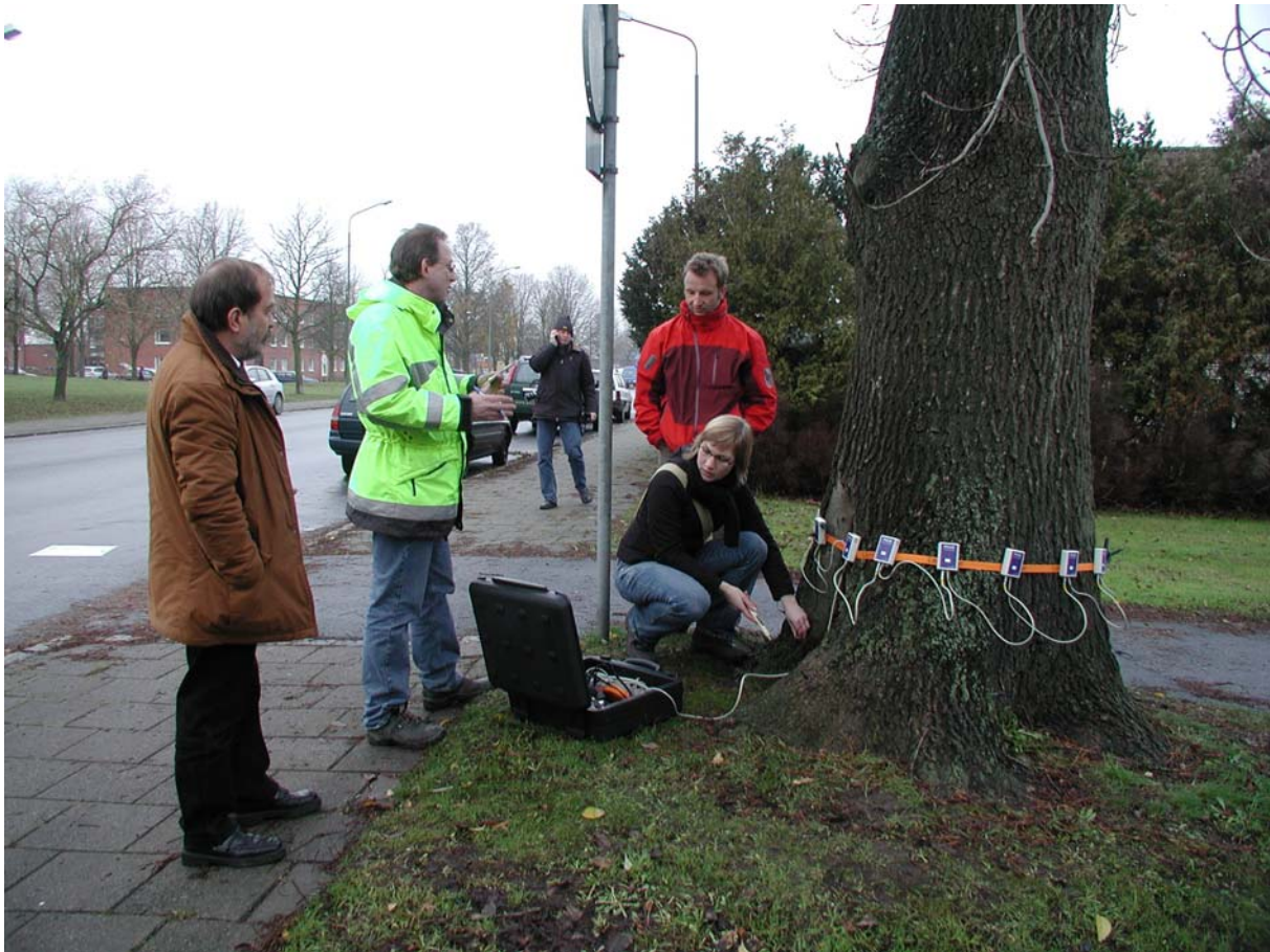
Figur 47. Mätning av träd i Malmö, december 2005, med hjälp av Picus-instrumentet.
