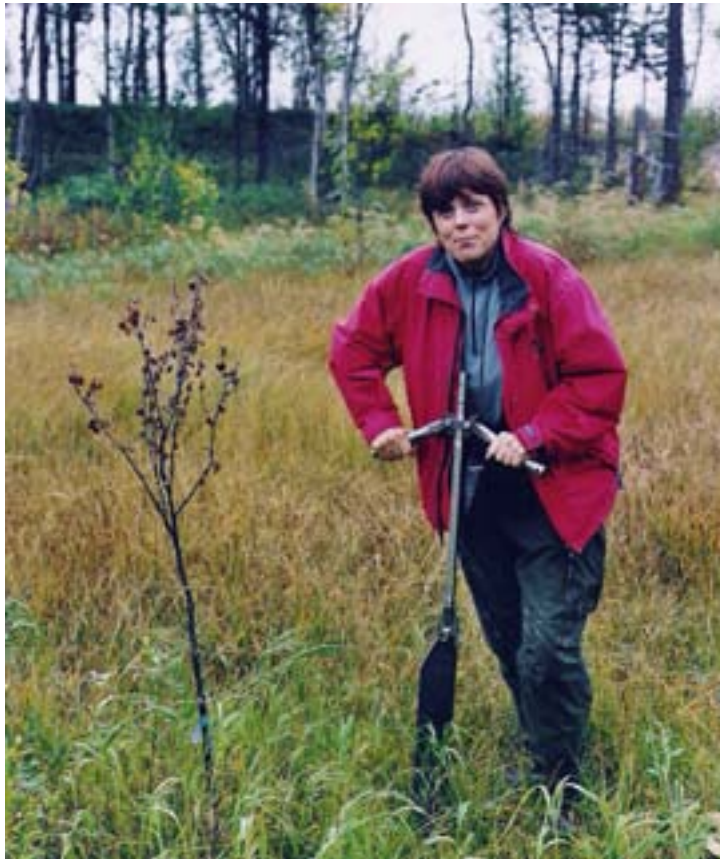
Figur 4. Provtagning på myren med en rysk torvprovtagare. På bilden visas författaren. Björkruskorna användes för att markera provtagningpunkten.
