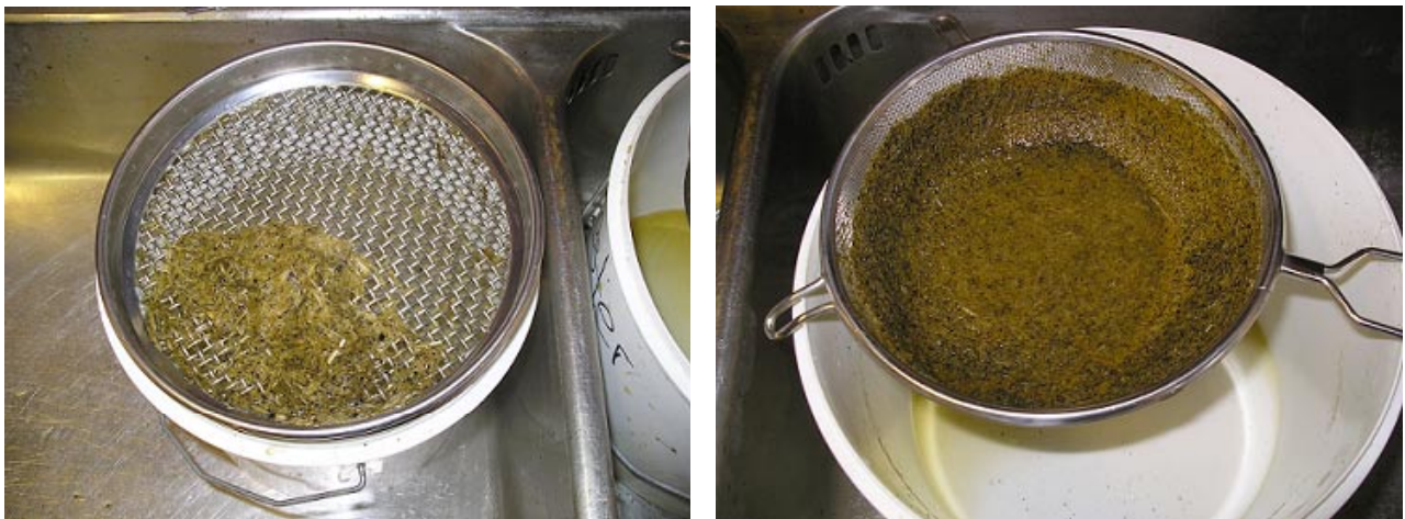
Figur 7. Våtsiktning av träck, till vänster såll med 4 mm maskstorlek och till höger såll med 1.7 mm maskstorlek.
