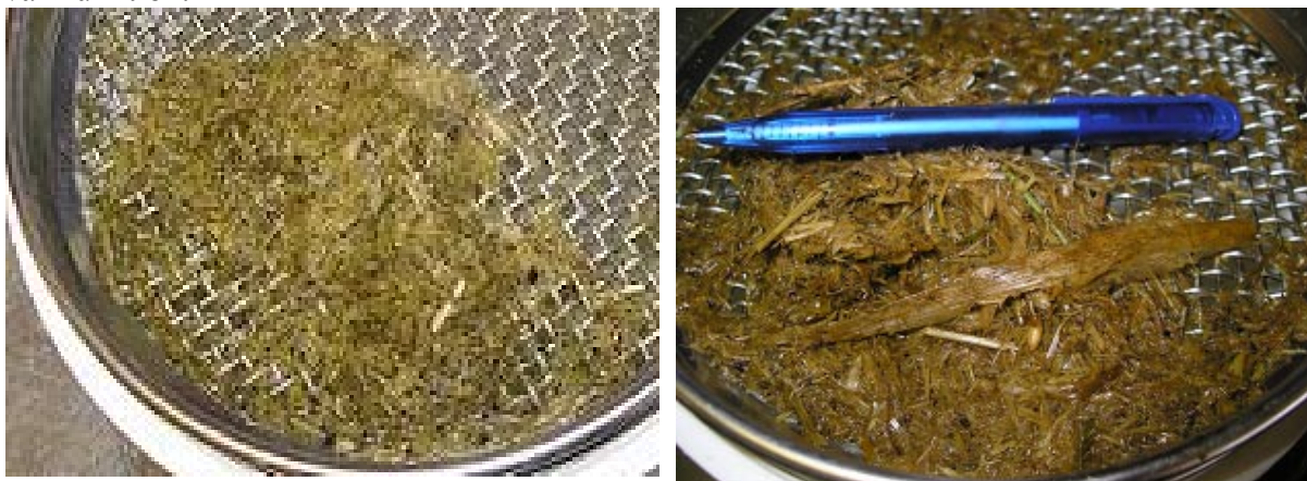
Figur 9. Siktad träck på såll med 4 mm maskstorlek. Till vänster träck där andelen partiklar längre än 2 cm är mycket liten och till höger träck där det finns en hel del partiklar längre än 2 cm. Den långa partikeln på den högra bilden var ungefär 15 cm.
